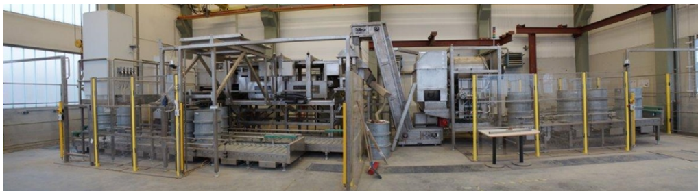
7. ábra: Földmérő berendezés (jobbra az anyag hozzavezetése a berendezéshez, balra a mérés és a szétválogatás)
