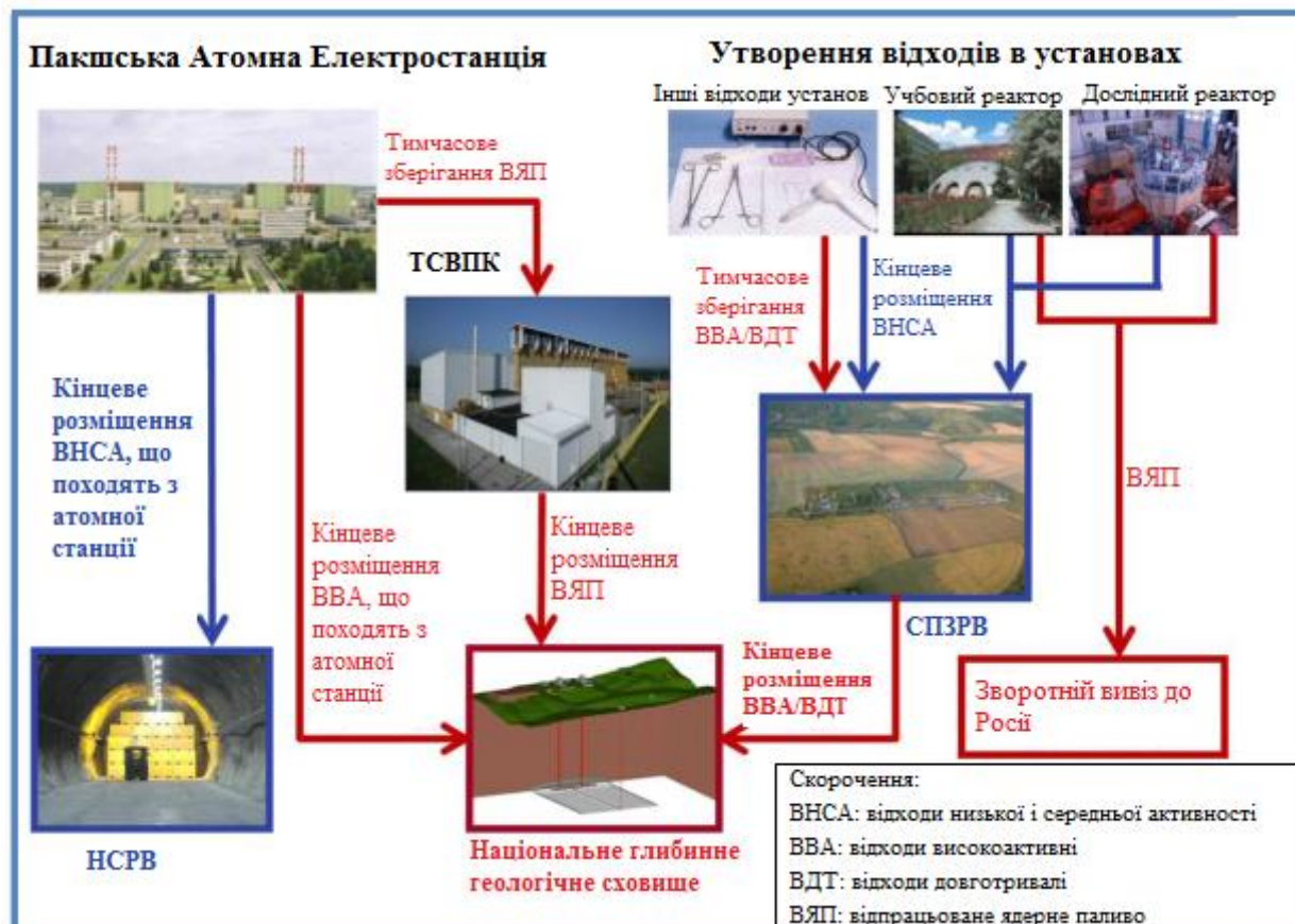
Малюнок 2-2 Блок-схема поводження з відпрацьованим ядерним паливом та радіоактивними відходами
