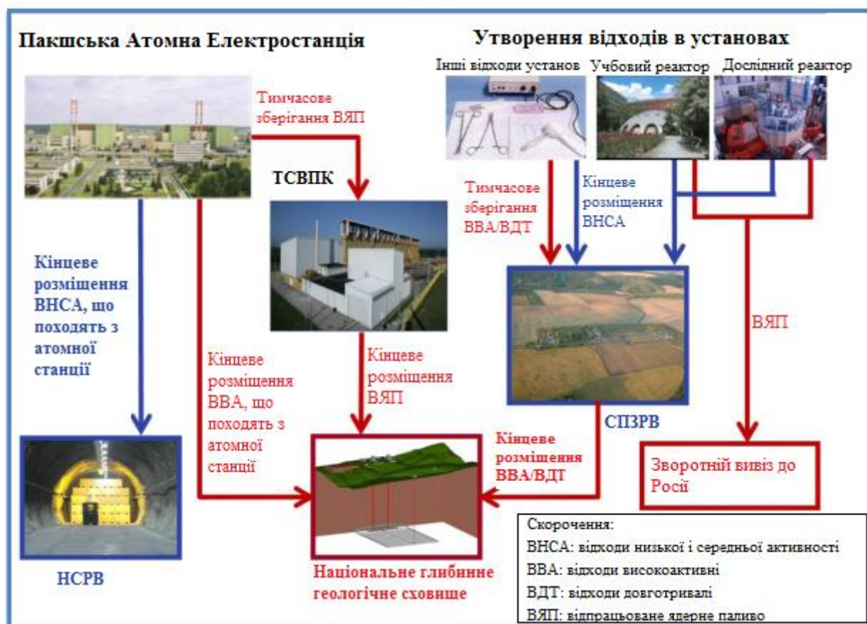
Малюнок 1 Логічна схема поводження з відпрацьованим ядерним паливом та радіоактивними відходами
